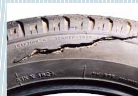
Rotura en el flanco
